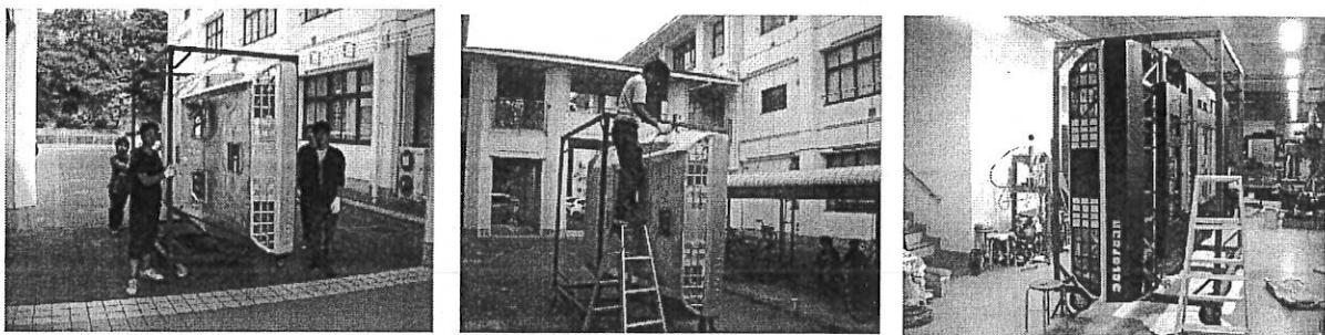
車体塗装用の移動枠を製作し、夏休みには車体を屋外に移動し、工作部員が総出で一日がかりで錆び止め塗装、マスキング、本塗装まで一気に行いました。
