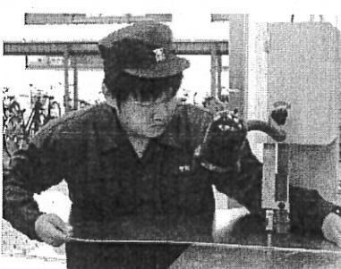
設計図を拡大印刷し、型紙を作成、アルミ板に転写して部品を切り出します。
